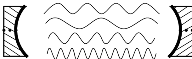
各種不同頻率的雷射光（符合共振腔駐波條件）同時輸出。
