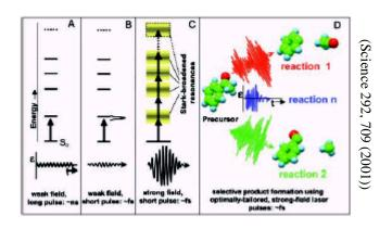
利用短而且高能量之脈衝雷射,造成能階之 增寬與分裂(AC stark effect),並藉由脈衝整 型控制化學反應及產物。圖 D 之紅色球為氧 原子;綠色球為碳原子;藍色球為氫原子。
