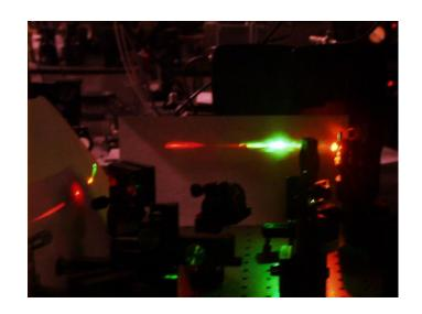
目前最新發展的超寬頻脈衝雷射,大大增加了量子控制的精緻性。圖中為此種鎖模脈衝雷射經過三稜鏡所分出的各種顏色的光,想像一支雷射可以製造出接近彩虹的光。照片攝自美國
