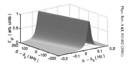
脈衝雷射之二個參數重複率 (repetition rate,  $\Delta$ )及偏頻頻率 (offset frequency,  $\delta$ )對 鋤原子雙光子躍遷率  $\Gamma_{gf}$  之影響。由此可見,適當的雷射光條件可改變原子的躍遷條件,甚至從不會躍遷到很強的躍遷。
